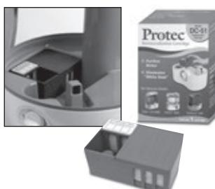
L'utilisation d'une cartouche déminéralisante Protec (PDC51 ou PDC51-CAN) aidera à réduire la poussière blanche. Pour de meilleurs résultats, la remplacer lorsque c'est nécessaire (tous les mois ou deux mois ou jusqu'à 30 remplissages sous utilisation normale) ou lorsque l'humidificateur n'a pas fonctionné pendant une période prolongée.
